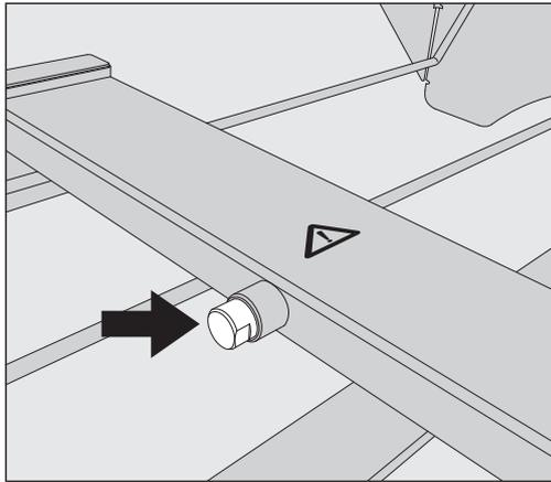
Aucune charge ni aucun dispositif de nettoyage ne doit empêcher l'accès ou être raccordé à cette zone. Une fois la mesure de pression de lavage effectuée, vous devez en refermer l'accès avec la vis borgne.
