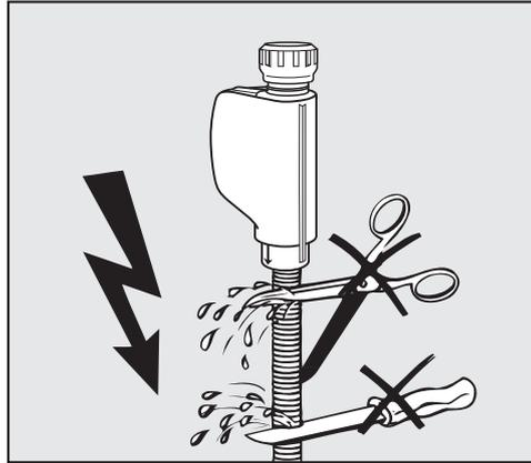
⚠ Les tuyaux d'arrivée d'eau ne doivent être **ni** raccourcis ni endommagés.
