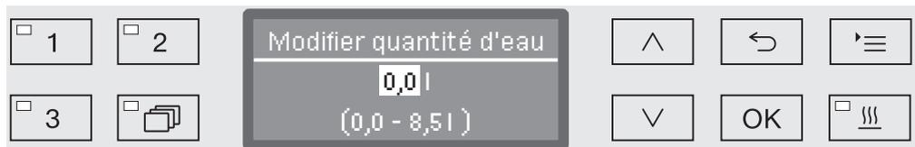
On peut soit augmenter le volume d'eau par paliers de 0,5 litre soit restaurer le réglage d'usine. La plage des réglages disponibles apparaît sur la dernière ligne, sachant que « 0 litre » correspond au réglage d'usine.
